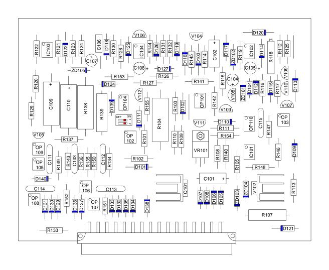
Figure 10 GUN TIME CONTROL P.C. BOARD P/N 600-0010
