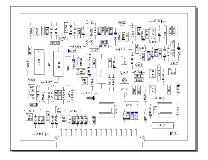
Figure 10 GUN TIME CONTROL P.C. BOARD P/N 600-0010
