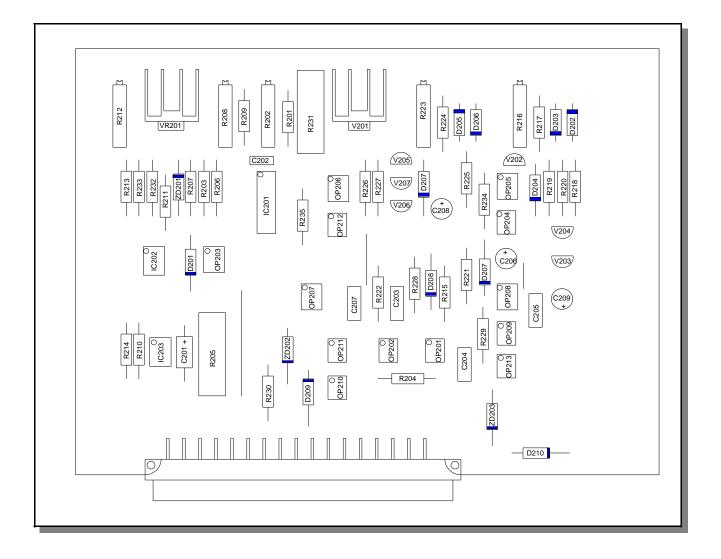
Figure 11 MONITOR P.C. BOARD P/N 600-0011
